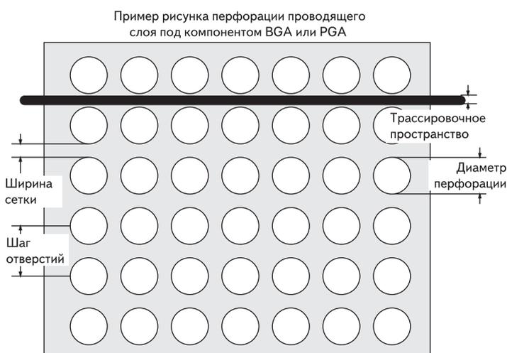
Рис. 5. Пример рисунка отверстий под компонентом BGA
