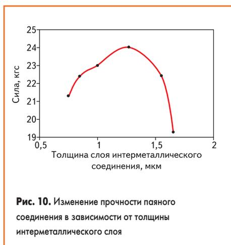
Рис. 10. Изменение прочности паяного соединения в зависимости от толщины интерметаллического слоя
