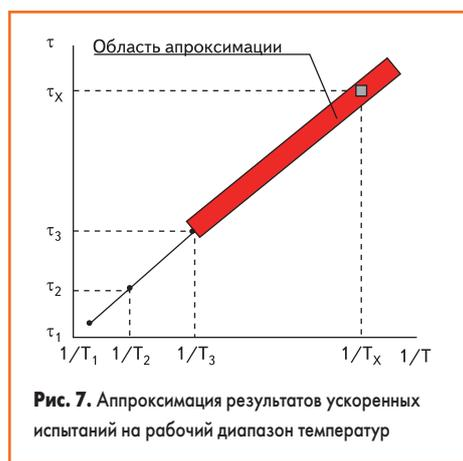
**Рис. 7.** Аппроксимация результатов ускоренных испытаний на рабочий диапазон температур
