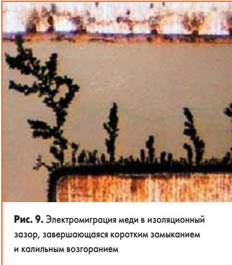
**Рис. 9.** Электромиграция меди в изоляционный зазор, завершающаяся коротким замыканием и калильным возгоранием
